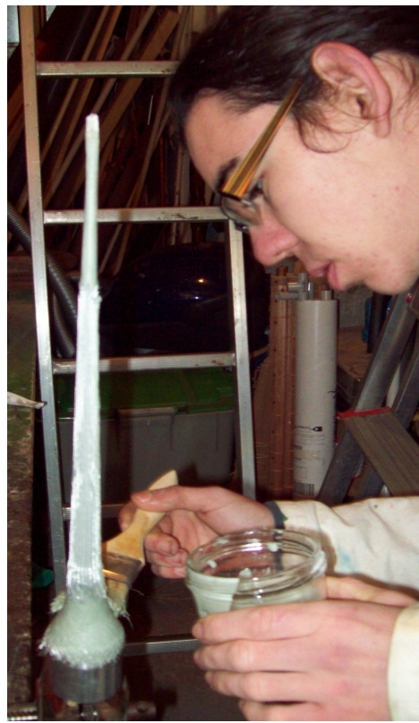
Application de la résine sur la fibre
