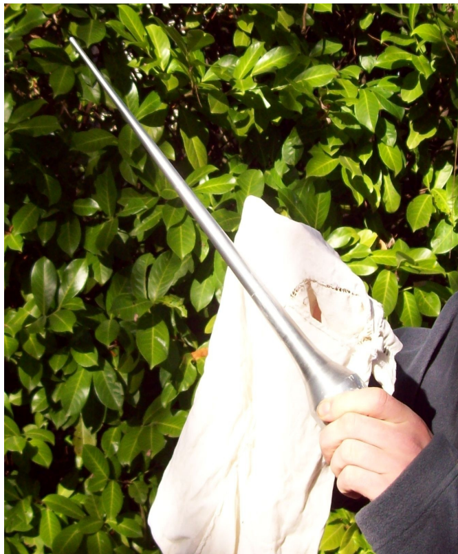
Cirage d'un mandrin en aluminium
